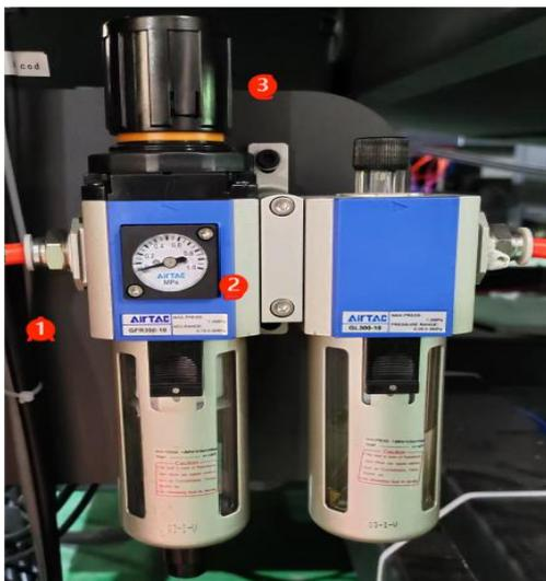
Conforme mostrado na figura acima, conecte a fonte de ar na posição 1, e a fonte de ar deve ser estável em 0,6-0,7mpa. Verifique o valor de pressão da fonte de ar atual na posição 2 e ajuste a válvula de pressão de ar na posição 3. Primeiro mova para cima para abrir a válvula, gire-a para cima no sentido horário e gire-a para baixo no sentido anti-horário.
